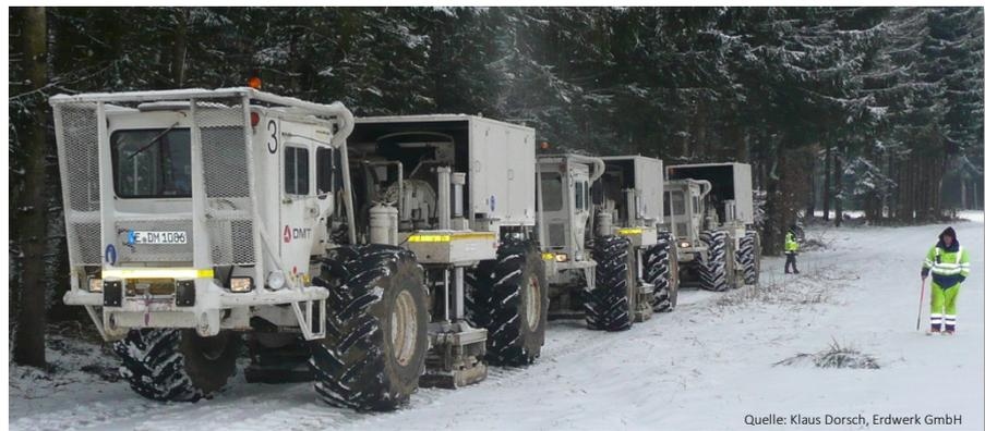
**Abb. 6:** Vibrationsfahrzeuge zur Erzeugung von seismischen Wellen, um die strukturellen Verhältnisse des geologischen Untergrundes zu untersuchen.
