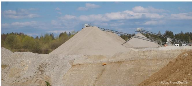
**Abb. 12:** Ein Teil des gewonnenen Schotters wird nach verschiedenen Korngrößen sortiert (Kieswerk bei Otterfing).
