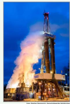
Abb. 2: Bohrturm beim Pumpversuch
